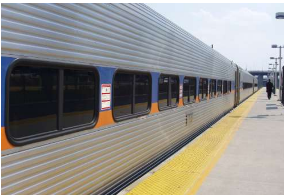
Figuur 25: Treinstellen met buitenpanelen uit austenitisch roestvast staal worden overal ter wereld gebruikt zonder problemen met galvanische corrosie.
