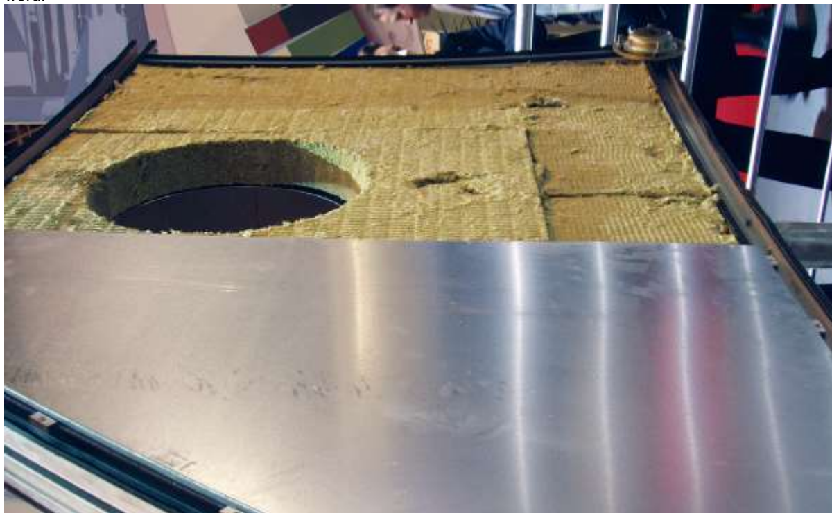
Figuur 18: Fabriceren van isolatiepanelen, gebruik makend van roestvast staal voor de buitenste schil en gegalvaniseerd koolstof staal voor de binnenste schil.
