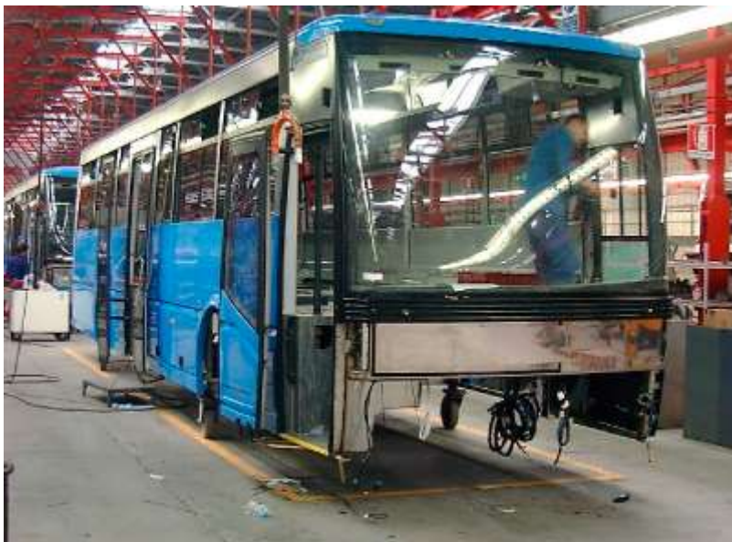
Figuur 24: Roestvast staal (gewoonlijk een gelakt ferritisch roestvast staal) heeft reeds bewezen dat het gemonteerd kan worden op een stalen chassis.
