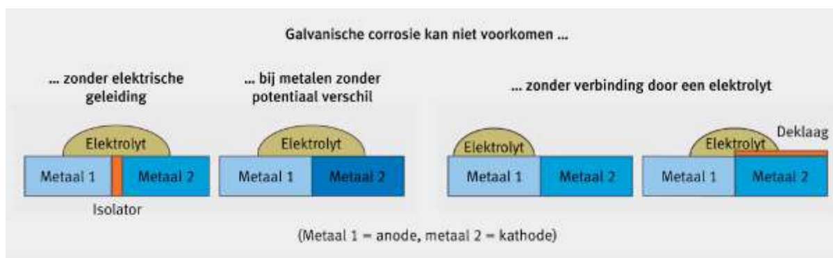
Figuur 3: Situaties waarbij galvanische corrosie niet kan voorkomen.
