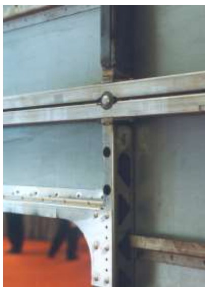
Figuur 23: In dit zijpaneel van een forensentrein zijn de constructiedelen en de buitenste panelen uit verschillende types roestvast staal gefabriceerd. Daar ze identieke potentialen hebben, kan er geen galvanische corrosie optreden.
